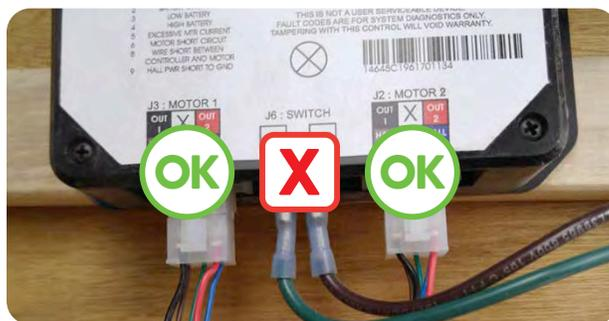
Déconnectez les deux fils du module du contrôleur de l'extension.
