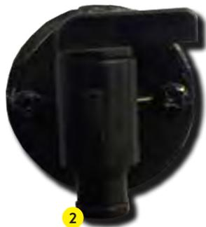
Vous devez toujours vider le réservoir d'eau propre en ouvrant la valve du drain avant d'entreposer la roulotte pendant une longue période. Lorsque la roulotte est en cours d'utilisation, vous devez le vider et le nettoyer tous les mois. Le système d'eau propre doit aussi être désinfecté lors de la première utilisation, après une longue période sans l'avoir utilisé ou bien si le système est contaminé.
