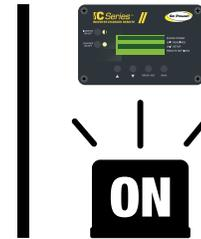
Il sera important qu'à chaque débranchement d'une source d'alimentation 120 volts, vous alliez mettre le contrôleur du panneau de l'onduleur à la position «OFF». Vous éviterez que votre onduleur ne convertisse de l'énergie pour rien et par le fait même vide votre batterie.
