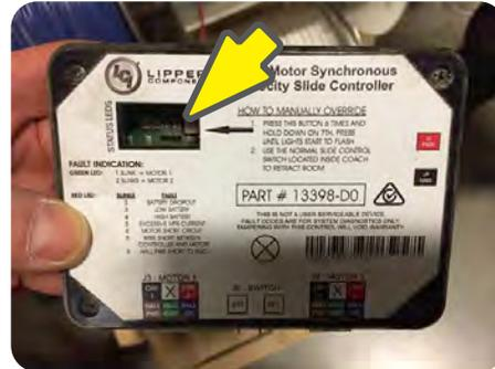
S'il s'agit d'un problème de moteur, vous serez incapable d'effectuer cette manoeuvre. Le contrôleur arrêtera la manoeuvre commandée à l'interrupteur. Vous devrez donc effectuer la manoeuvre suivante:
