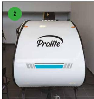
2 Toit en fibre de verre monocoque
