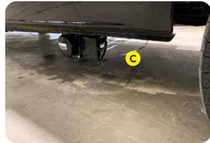
C Valve de drainage des eaux usées E-Volution MS
