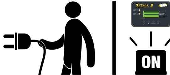
Il sera important qu'à chaque débranchement d'une source d'alimentation 120 volts, vous alliez mettre le contrôleur du panneau de l'onduleur à la position «OFF». Vous éviterez que votre onduleur ne convertisse de l'énergie pour rien et par le fait même vide votre batterie.
