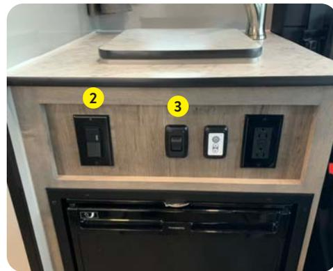
2. Interrupteur de chauffe-eau
